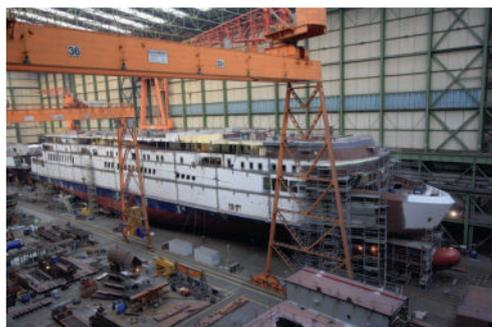
**Rohbau einer Scandlines-Fähre Foto: Scandlines**
